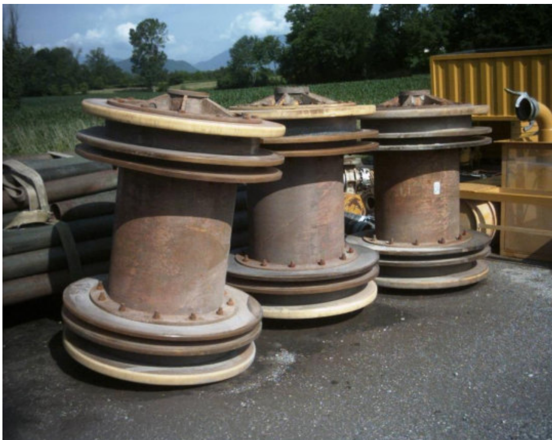
Foto 7.1.13/B - Pig per collaudo idraulico
